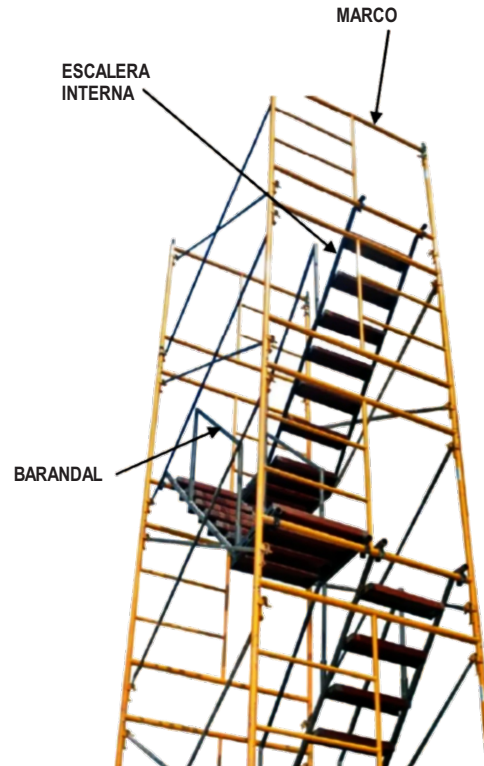
Torre con escaleras internas
